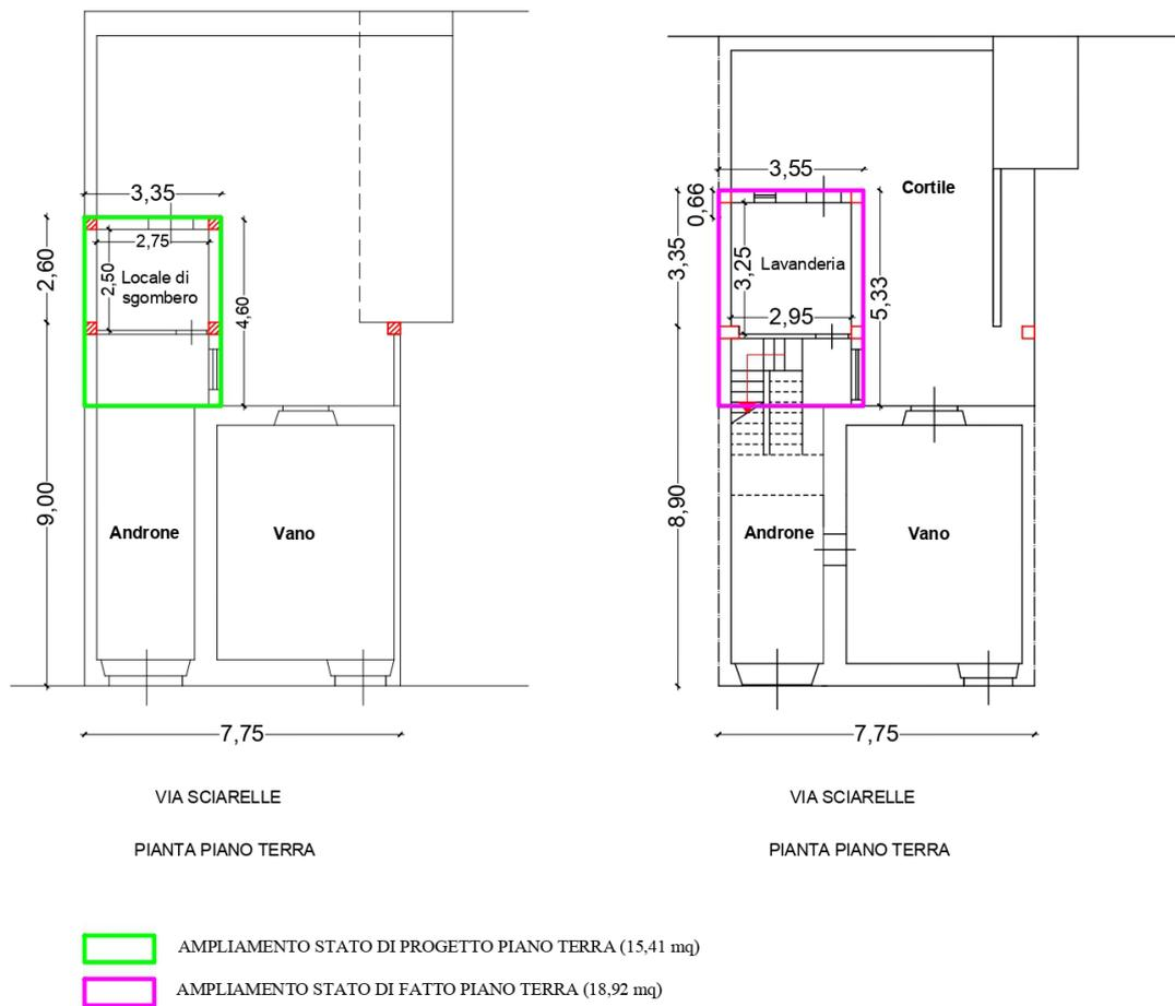
Figura 2 – Ampliamento piano terra come da progetto e come da rilievo
