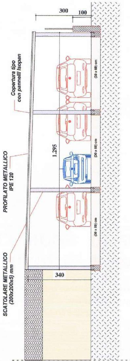
**PROSPETTO - SEZIONE TETTOIA n. 1 - Scala 1:100**
