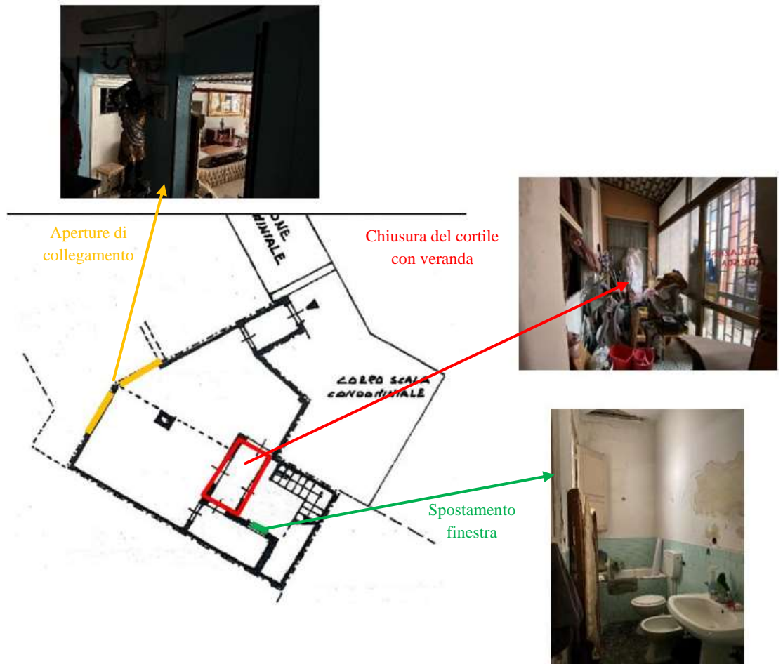
Planimetria catastale dell'immobile (fuori scala) e foto relativa alle difformità riscontrate
