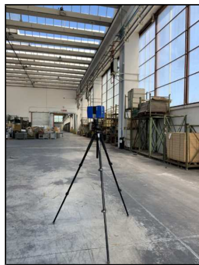
Laser Scanner 3d per il rilievo interno
