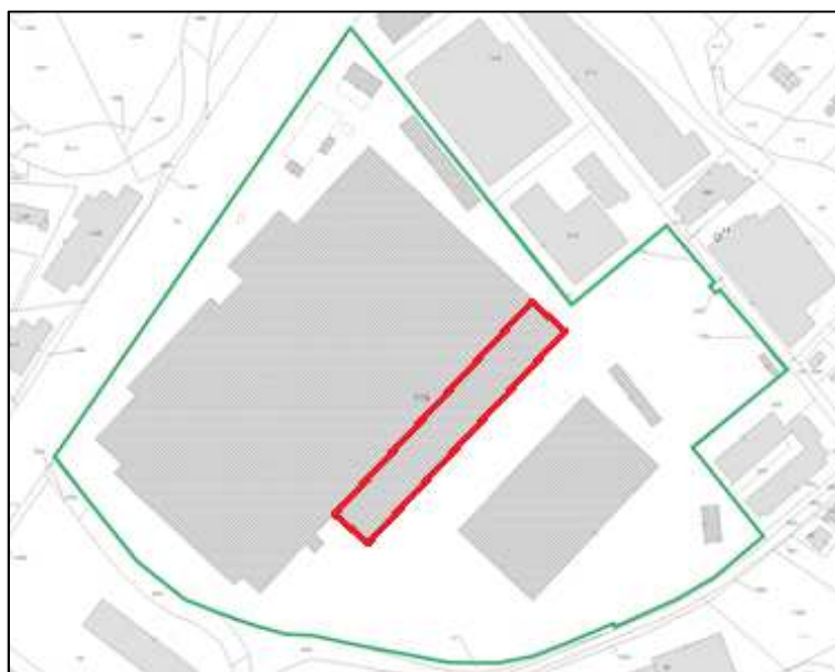
Estratto catastale del Foglio 96 Particella 115 sub 3, 4 e 9. In rosso vi è la porzione della copertura, ampliamento del 2003, interessata dal problema di inflessione delle travi.
