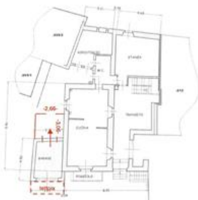
PIANO TERRA - IN EVIDENZA LE MODIFICHE RAVVISATE
