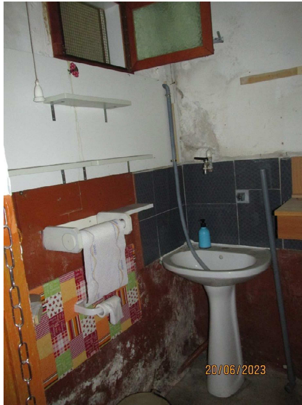
Fotografia 19 – Bagno: è dotato di tazza igienica e lavabo; le pareti sono in parte rivestite con intonaci ordinari e tinteggiati con pittura lavabile, in parte risulta rivestito con piastrelle in ceramica. L'ambiente dispone di una finestra che affaccia nel "Locale 1".
