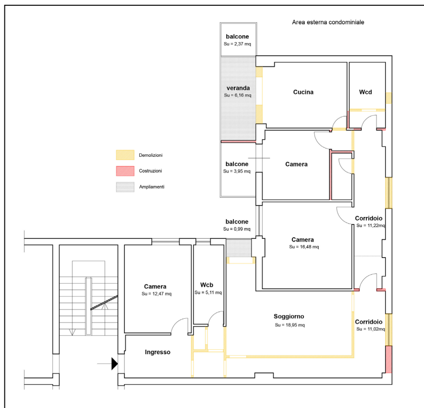
Planimetria di rilievo attuale con indicazione delle difformità rispetto al grafico di progetto autorizzato
