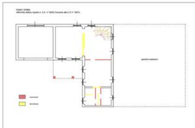
difformità piano terra
