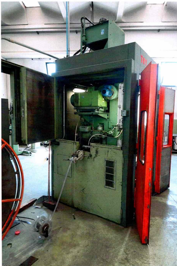
Foto 3 – T01 – Pressa Bruderer BSTA 20E – matricola 8512 - Cabina di insonorizzazione
