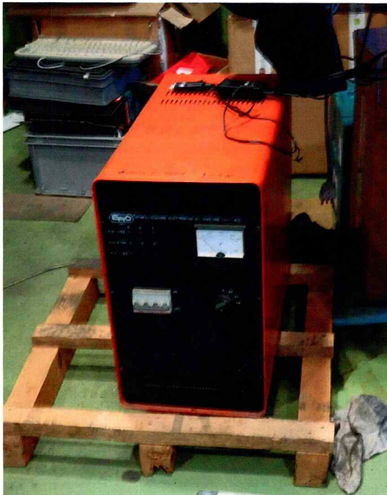
Foto 36 - Rif. 152 - STABILIZZATORE TENSIONE 3FASI 18KW ERC
