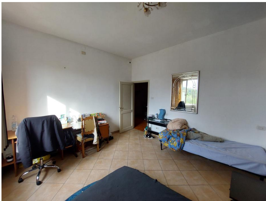
Foto n.23: Particolare della camera più grande al secondo piano. È visibile al centro la porta in legno che delimita l'ingresso alla camera. Notare, il pavimento in monocottura, l'impianto elettrico sottotraccia e le pareti intonacate e tinteggiate.
