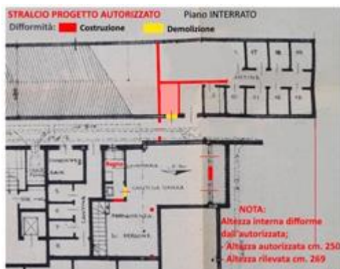
Difformità piano Interrato
