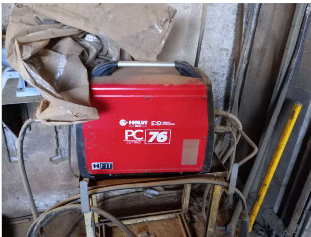
Rif. n. 21: Saldatrice portatile al plasma HELVI Pc EVO 76
