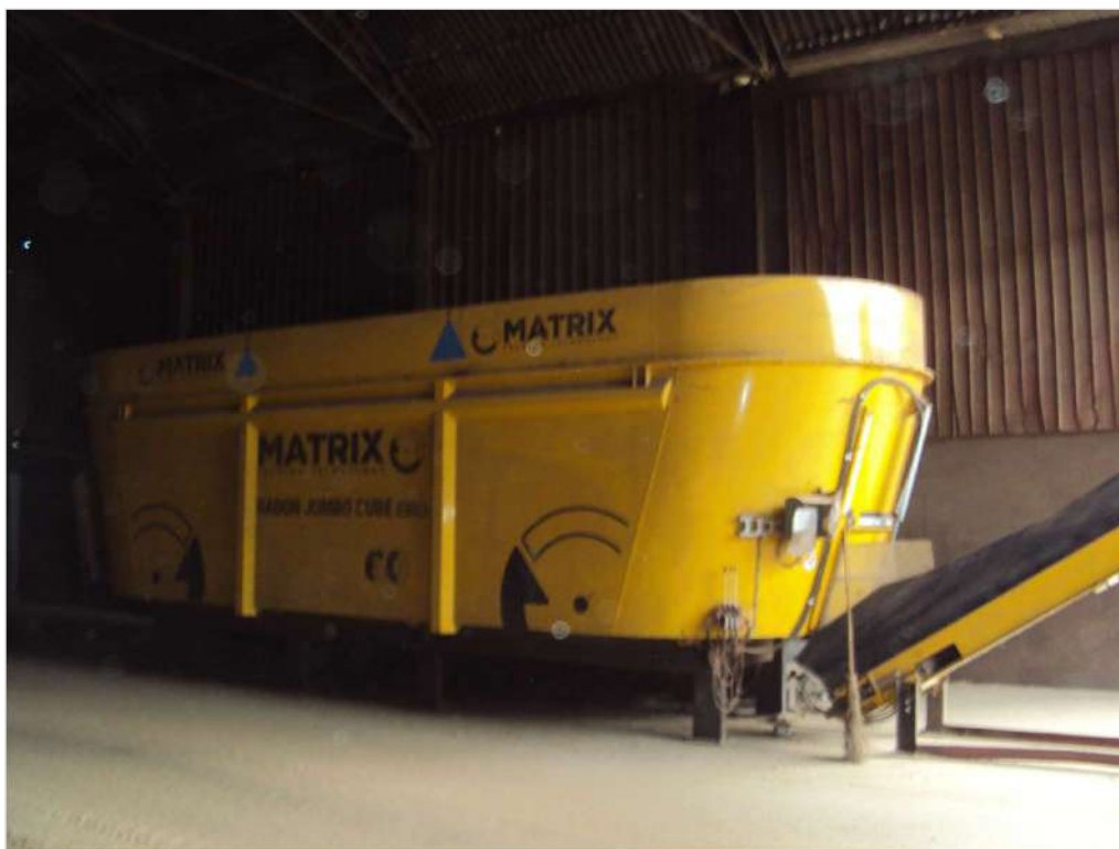
Rif. n. 6: Carro trincia-miscelatore Italmix mod. MATRIX
