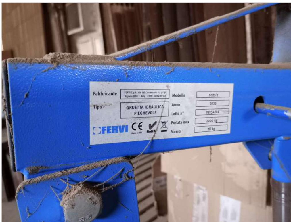
Rif. n. 31: Gruetta idraulica pieghevole FERVI 0021/2 (portata max. 2.000 kg)
