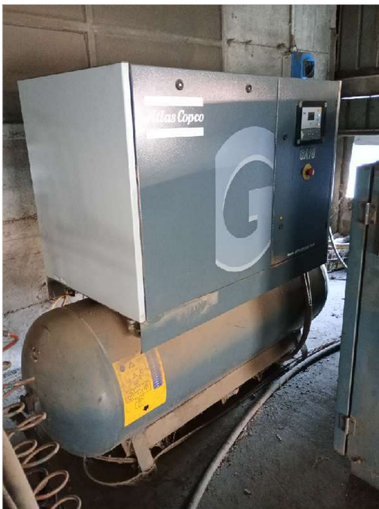
Rif. n. 32: Compressore a vite ATLAS COPCO GA 18
