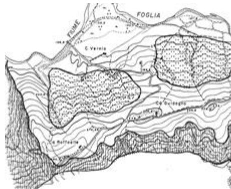
PRG 1994, Tav. 201.I A4 - Carta della pericolosità geologica: il compendio ricade pressoché interamente nell'area puntinata a sinistra (movimento lento della copertura detritica)
