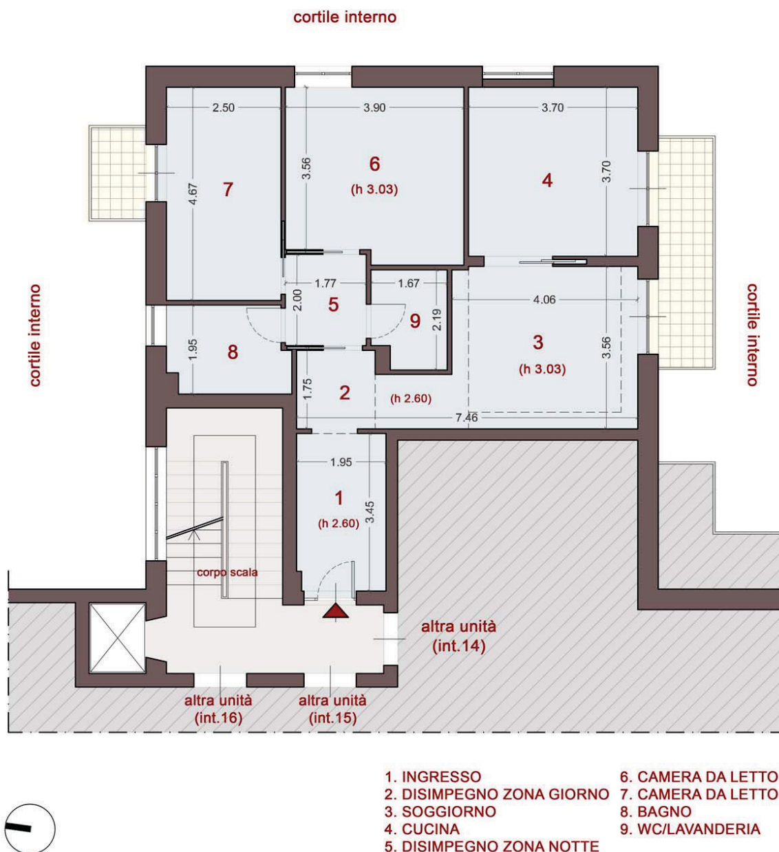
gr2.01: pianta stato di fatto APPARTAMENTO
