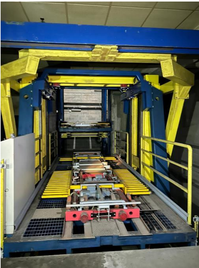
Montacarichi movimentazione veicoli
