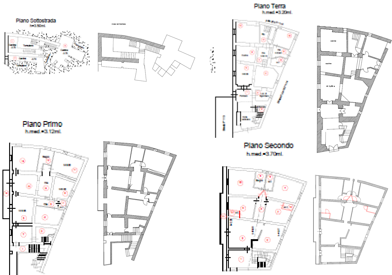
Fig. 13 confronto dello stato reale dei luoghi e l'allegato grafico alla DIA dell'immobile, oggetto di pignoramento.
