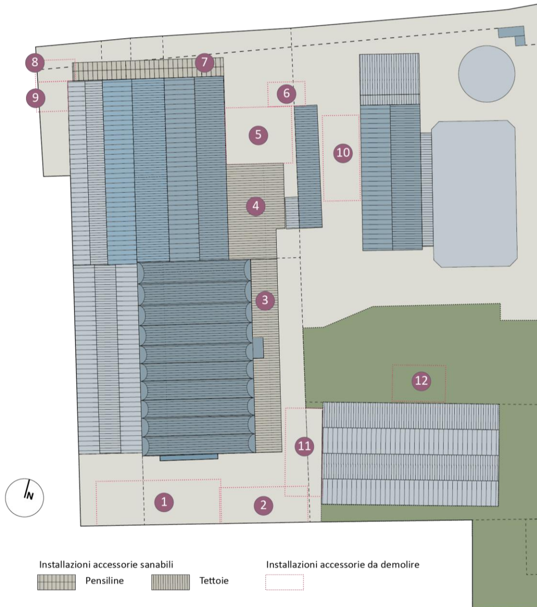
Figura 6. Schema dell'ipotesi ottenibile per effetto della sanatoria delle installazioni accessorie
