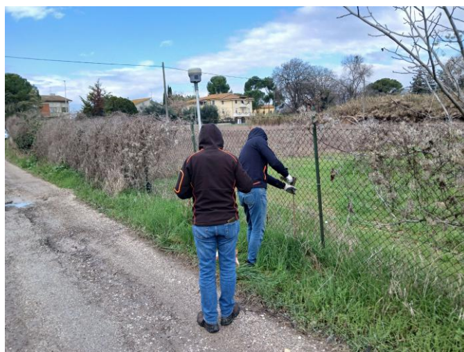
Operazioni di riconfinamento e picchettamento mediante utilizzo di strumentazione GPS
