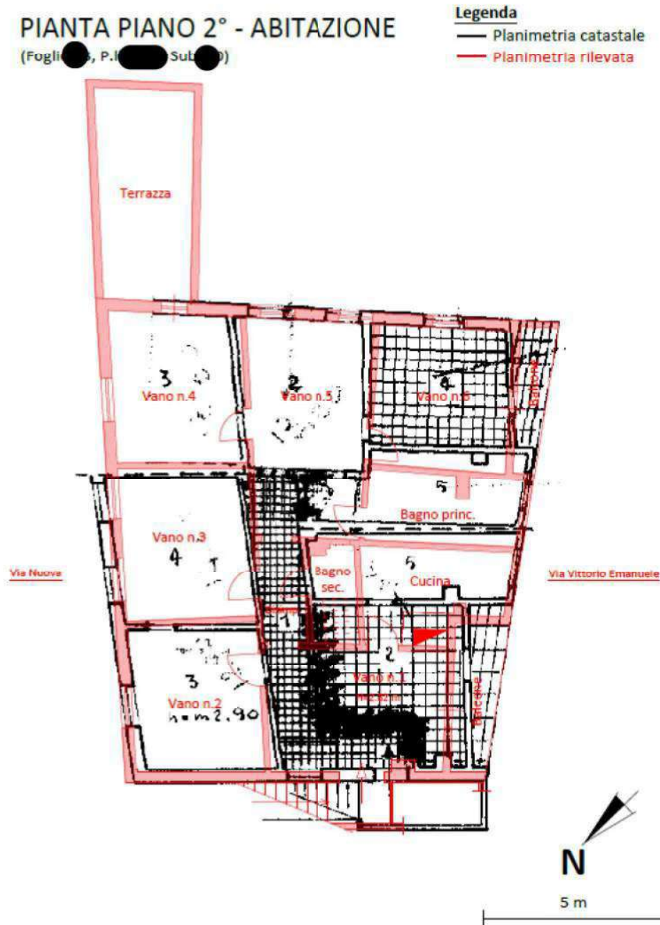
Figura 28 - Sovrapposizione stato reale dei luoghi e accatastamento presentato all'ex Ufficio Tecnico Erariale il 26.10.1957 - Elaborazione ottenuta dall'unione dei due stralci planimetrici presenti in atti
