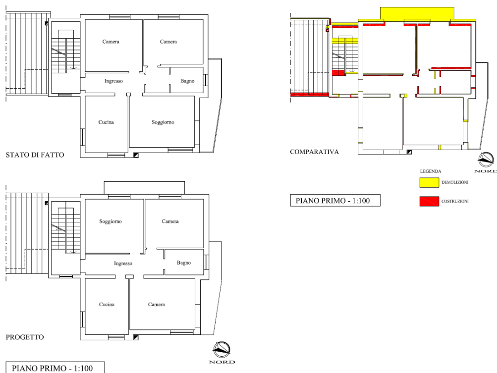
Figura 20 Planimetrie appartamento - stato di fatto – progetto – comparativa (fuori scala) – ( Allegato L.04.04 )
