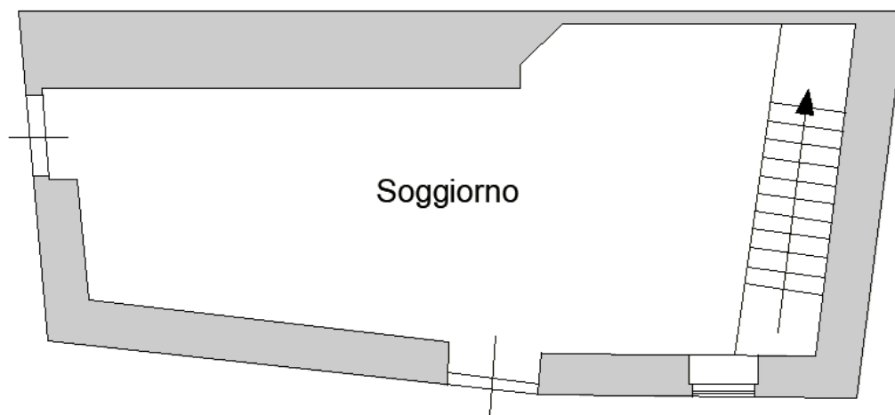
Figura 13 Stato reale dei luoghi piano primo
