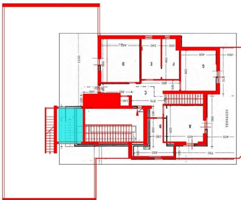
Allegato 10f- Sovrapposizione del reale stato dei luoghi (in rosso) rispetto la planimetria del condono. Retino azzurro indica la posizione della piscina che occupa anche parte del ballatoio
