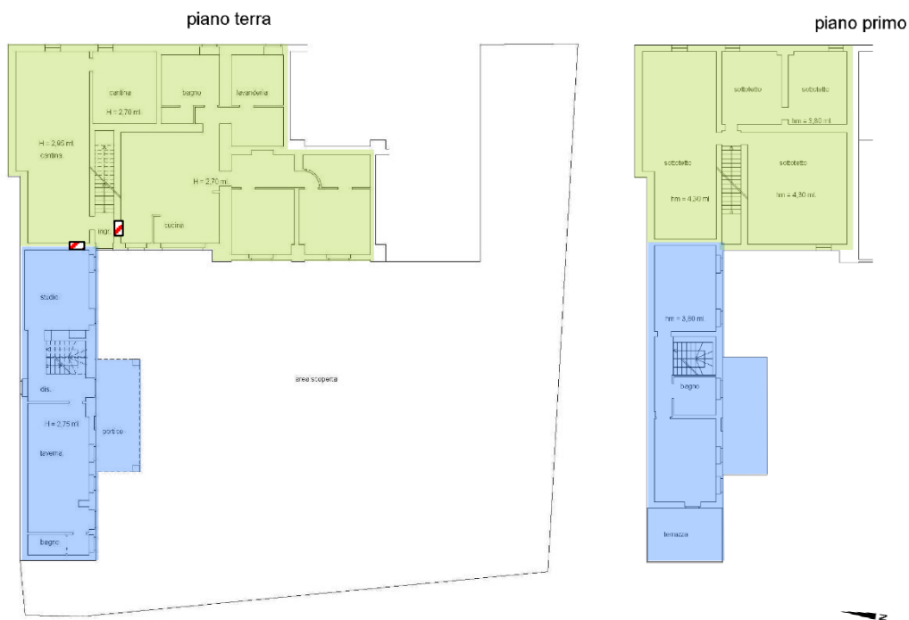
Figura 5 - Stralcio della planimetria catastale con evidenziate e due unità abitative autonome (riempimento di colore verde e azzurro), e le aperture di collegamento interne al piano terra inesistenti (tratteggiato rosso)
