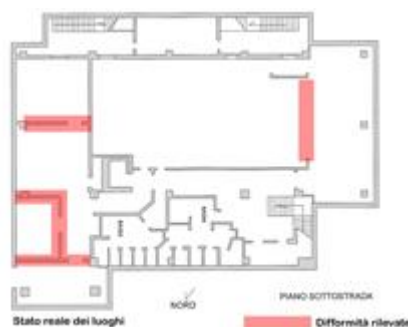
Stato reale dei luoghi PIANO SOTTOTERRA Difformità rilevate
