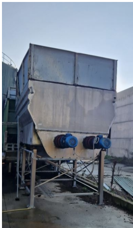
tramoggia di carico e sistemi coclea "Franzosi" ( macchinario soggetto a leasing contratto SI93350 del 25/02/2022)
