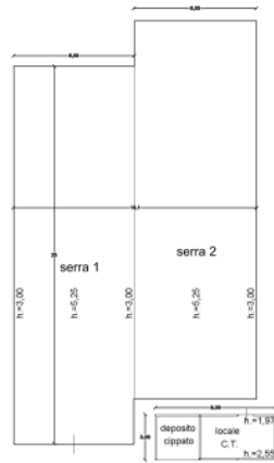
A - Immobili per attività agricola composti da fabbricato principale al P.S1-T-1, deposito, C.T., serre e terreni - Rilievo serre e C.T. con deposito cippato
