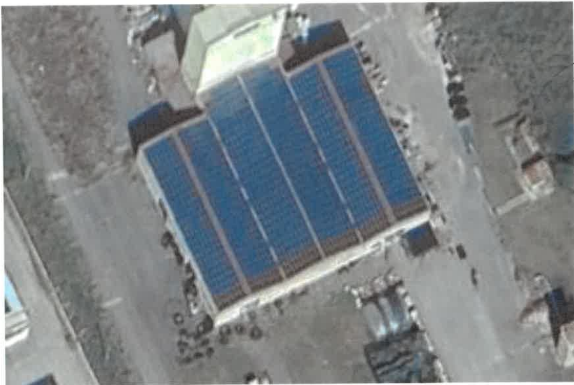
Impianto fotovoltaico installato nella copertura del magazzino di dimensioni m. 41 x 52
