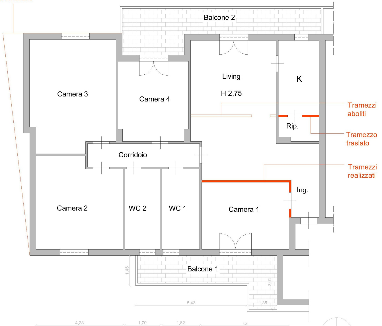
GRAFICI DI RILIEVO CON INDICAZIONE DELLE DIFFORMITA' EDILIZIE - APPARTAMENTO SITO AL SECONDO PIANO, SCALA B, INT. 7 - CASAPULLA (CE) VIA A. DIAZ. N. 48 - IN CATASTO AL FOGLIO 5, P.LLA 5001, SUB 37, CAT. A/2. - SCALA 1:100
