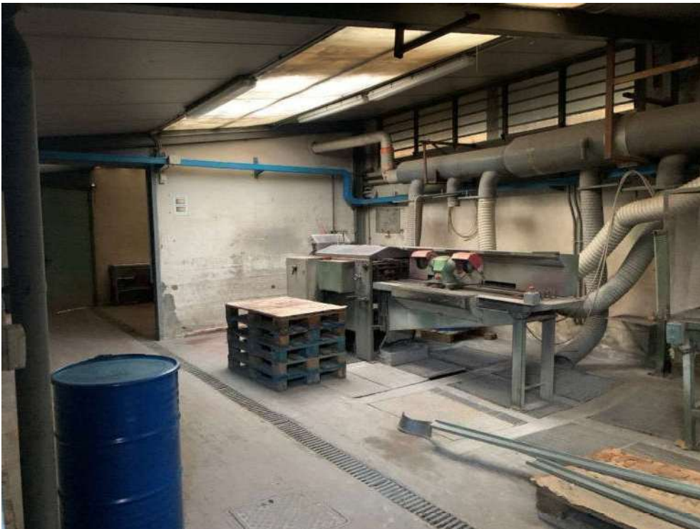
Fotografia 18: Macchine per taglio e spazzolatura (M9)
