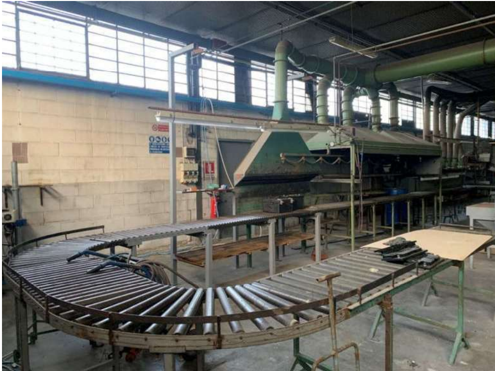
Fotografia 22: Linea termo saldatura manuale con caldaia fusione bitume (M7)
