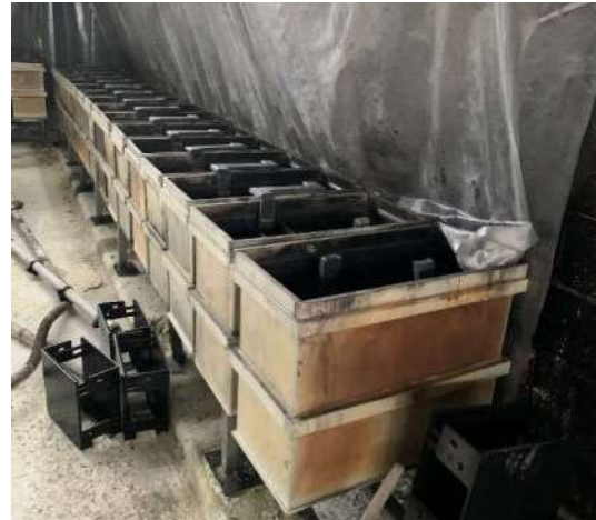
Vasche piccole contenenti acido solforico
