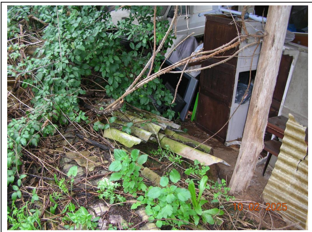
Foto 16 Lastre di copertura ondulata in cemento amianto
