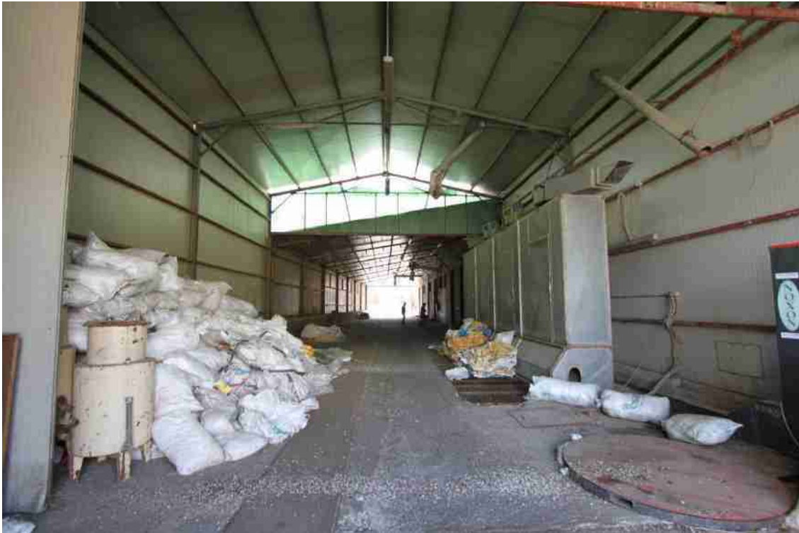
Figura 57_Tettoia laterale allo stabilimento: zona ribaltabile per camion a cassa fissa-tramoggia filtri e piattaforma rotante
