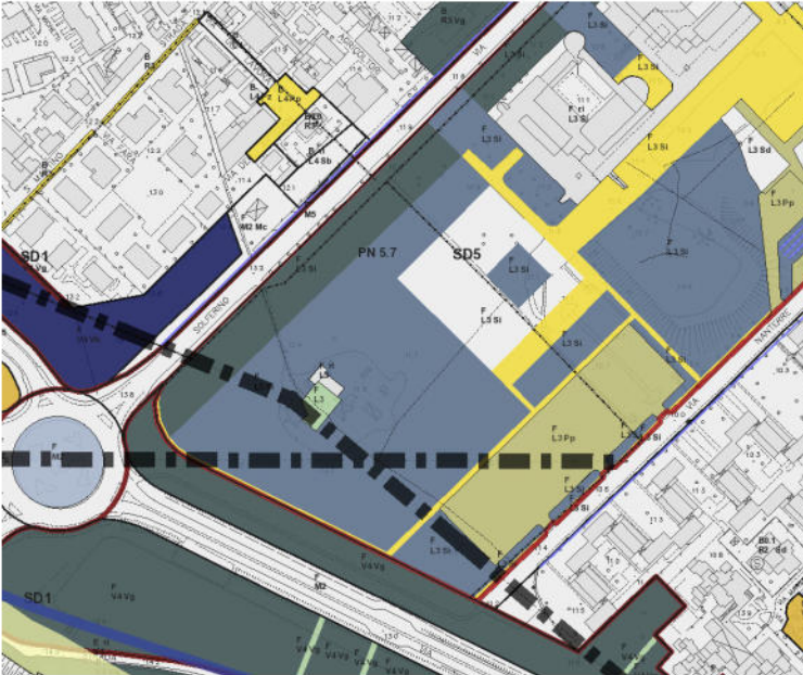
Vincolo Elettrodotto su tralicci
