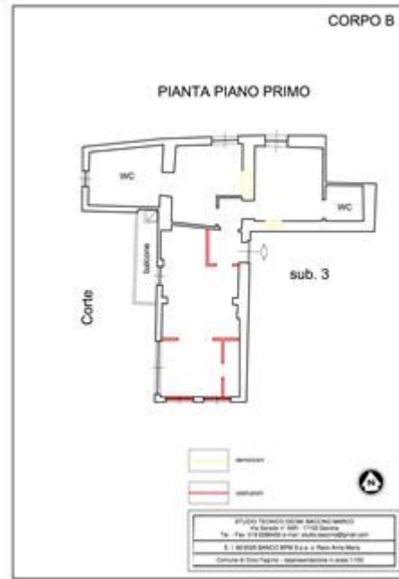
Planimetria di rilievo con individuazione irregolarità urbanistiche
