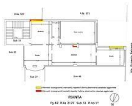
Planimetria dello stato reale dei luoghi con opportuna indicazione grafica delle riscontrate difformità catastali
