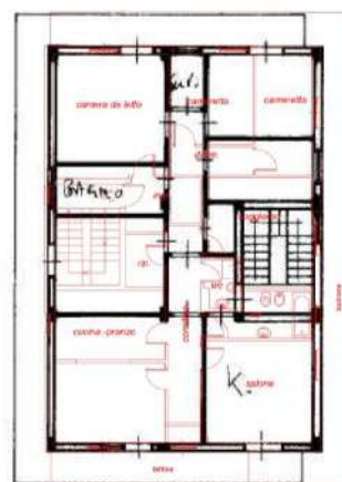
sovrapposizione tra planimetria catastale e planimetria rilevata
