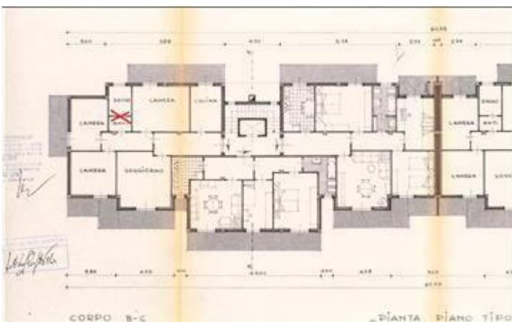
Pianta tipo degli appartamenti corpo B-C nella Concessione n.12 del 1979, prot.179_CONFORME con lo stato dei luoghi. Di fatto è stato demolito il piccolo divisorio posto tra bagno e antibagno.
