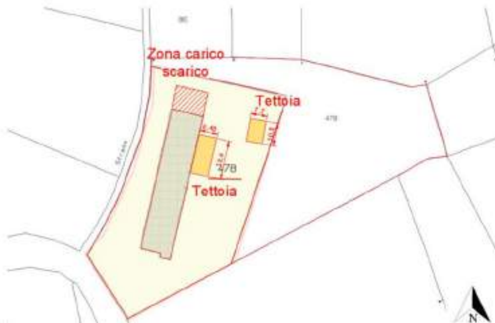
Figura 129: per individuare gli accrescimenti non legittimati in Comune, si fa riferimento ad una planimetria catastale, ove ad est vengono indicate due tettoie una di dimensioni 7,70mx 10,80m circa e l'altra (posta in aderenza all'edificio) circa 8,48mx18c40m, oltre alla zona di carico e scarico, che risulta area cementata, con pilastri che non crea volumi
