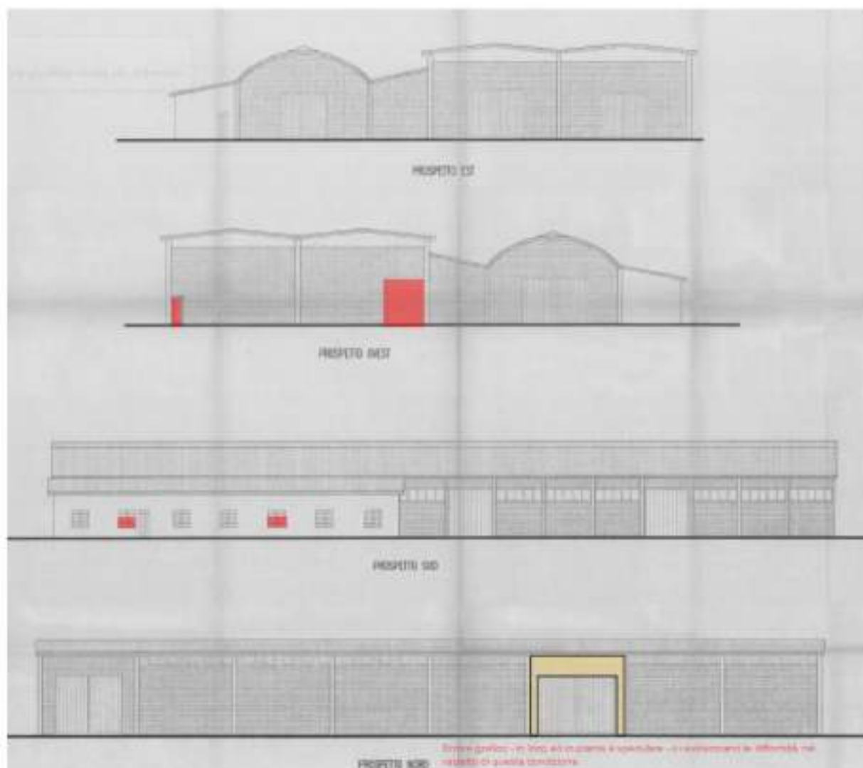
Figura 125: Si riportano a titolo indicativo e non esaustivo alcune difformità rilevate rispetto ai documenti presenti in atti nella Concessione edilizia 7984 del 29/03/2000: Prospetto Ovest la chiusura di due aperture, prospetto Sud la riduzione di due finestre (che risultano condonate con sanatoria rilasciata il 14/10/1992 n. 1053) e prospetto Nord un'apertura più ampia e lo spostamento di una porta (per quest'ultimo si suppone l'errore grafico poiché la pianta risulta essere corretta) - - Fuori Scala
