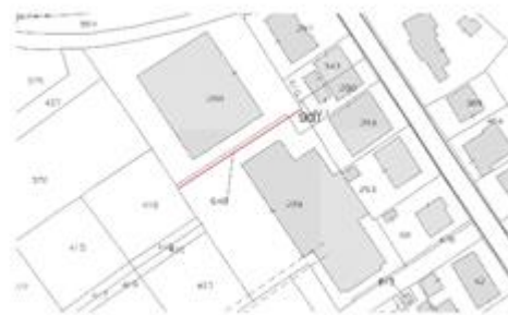
Linea di confine reale rettilinea realizzata con muro e soprastante ringhiera metallica - ad integrazione del p.to 8 della relazione
