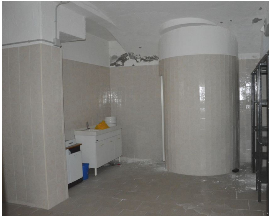
Illustrazione 12: Cantina formaggi posta al piano seminterrato e vano scale circolare entro cui trova collocazione chiocciola di distribuzione verticale al livello superiore. Si evidenziano diffuse esfoliazioni degli intonaci.
