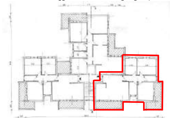
Figura 5 – Difformità emerse dal raffronto tra gli elaborati progettuali e la restituzione grafica dell'attuale stato di fatto dell'alloggio. Il locale ad uso di garage di pertinenza esclusiva appare sostanzialmente conforme.
