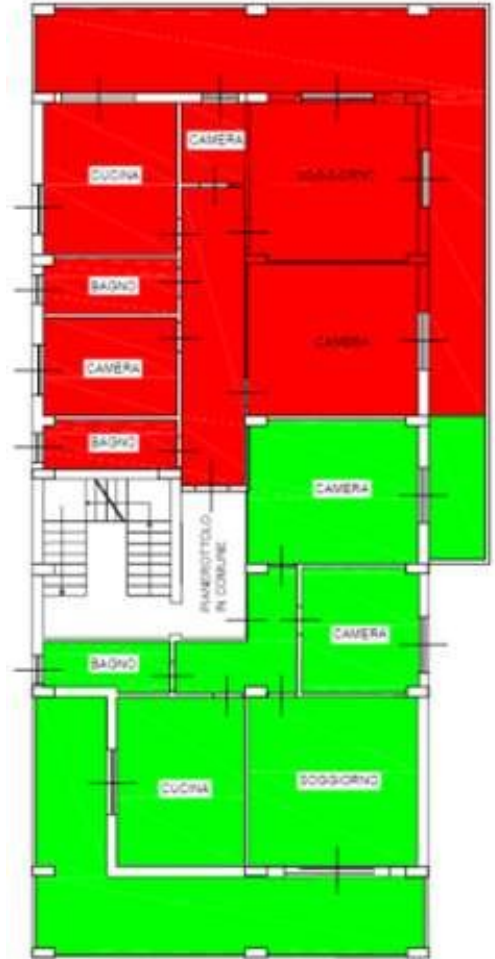
Distinzione delle 2 unità abitative
