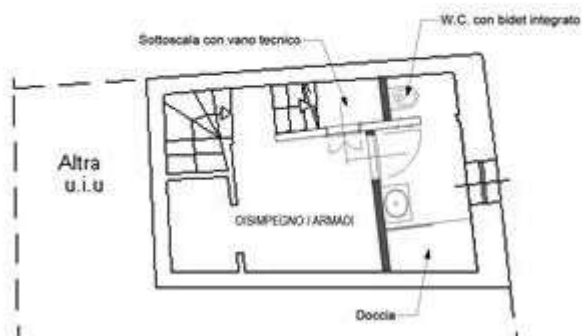
Ipotesi di realizzazione bagno al piano primo
