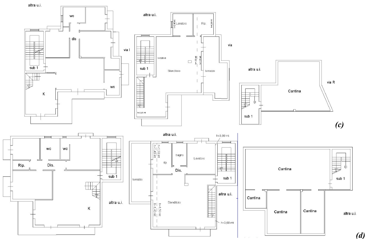
Figura 4. Planimetrie degli appartamenti e relativi accessori ubicati in via Giro Esterno n° 1/C - piani 1, 2, 3 e S1: BENE A P1 e S1 (a); BENE B P1 e S1 (b); BENE C P2, P3 e S1 (c); BENE D P2, P3 e S1 (d).
