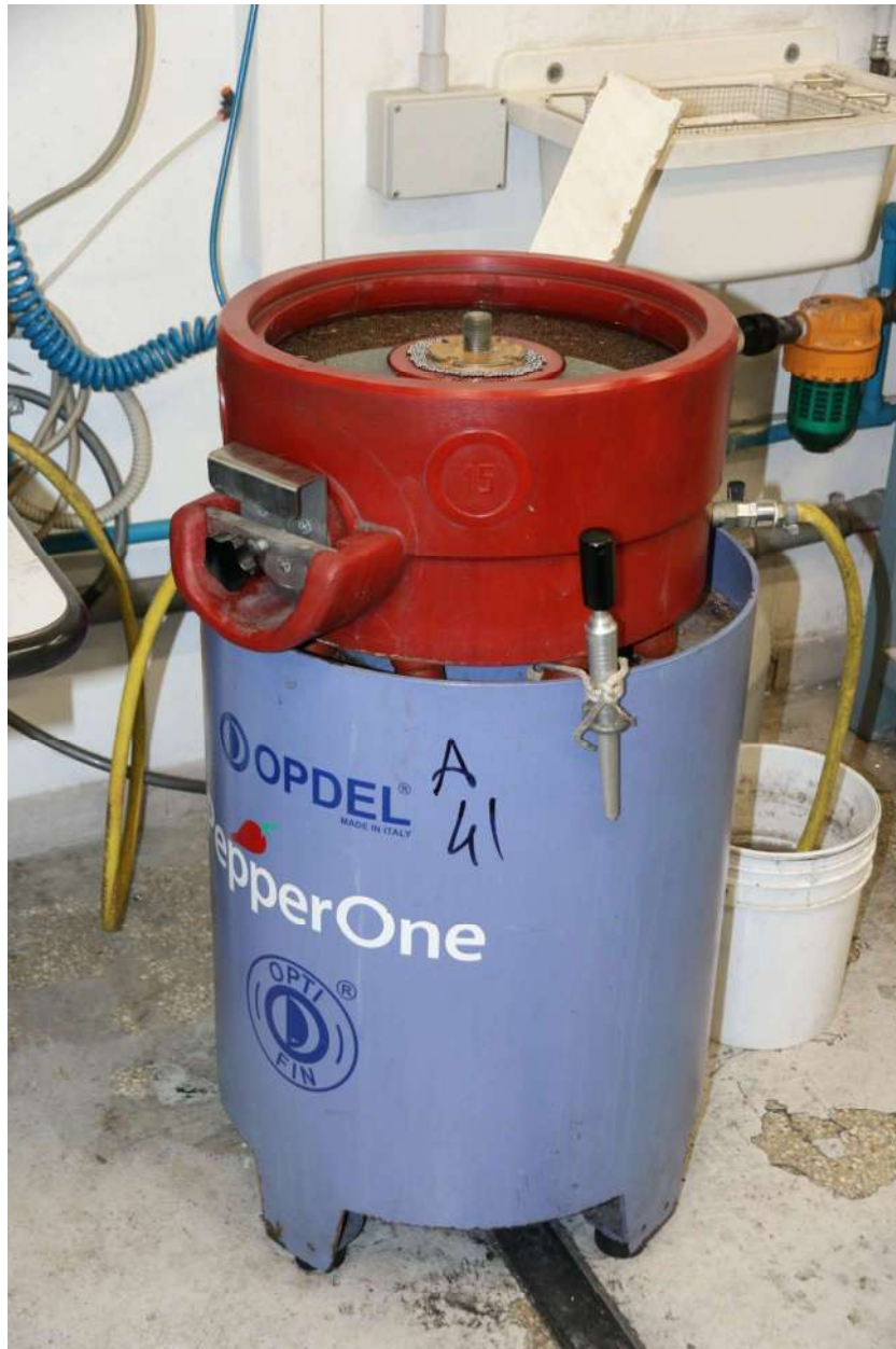
( complessivo del vibratore circolare )
