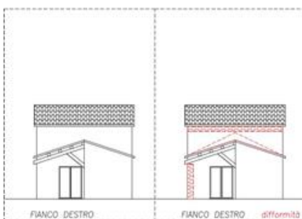
Sub. 2: sui prospetti di progetto (parte integrante del Permesso in Sanatoria / Accertamento di Conformità N. 2006/43) - riprodotti al CAD - sono evidenziate la presenza della colonna d'angolo in mattoni e la maggior pendenza delle falde
