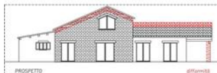
Sub. 2: sui prospetti di progetto (parte integrante del Permesso in Sanatoria / Accertamento di Conformità N. 2006/43) - riprodotti al CAD - sono evidenziate in rosso le principali difformità rilevate nei fronti
