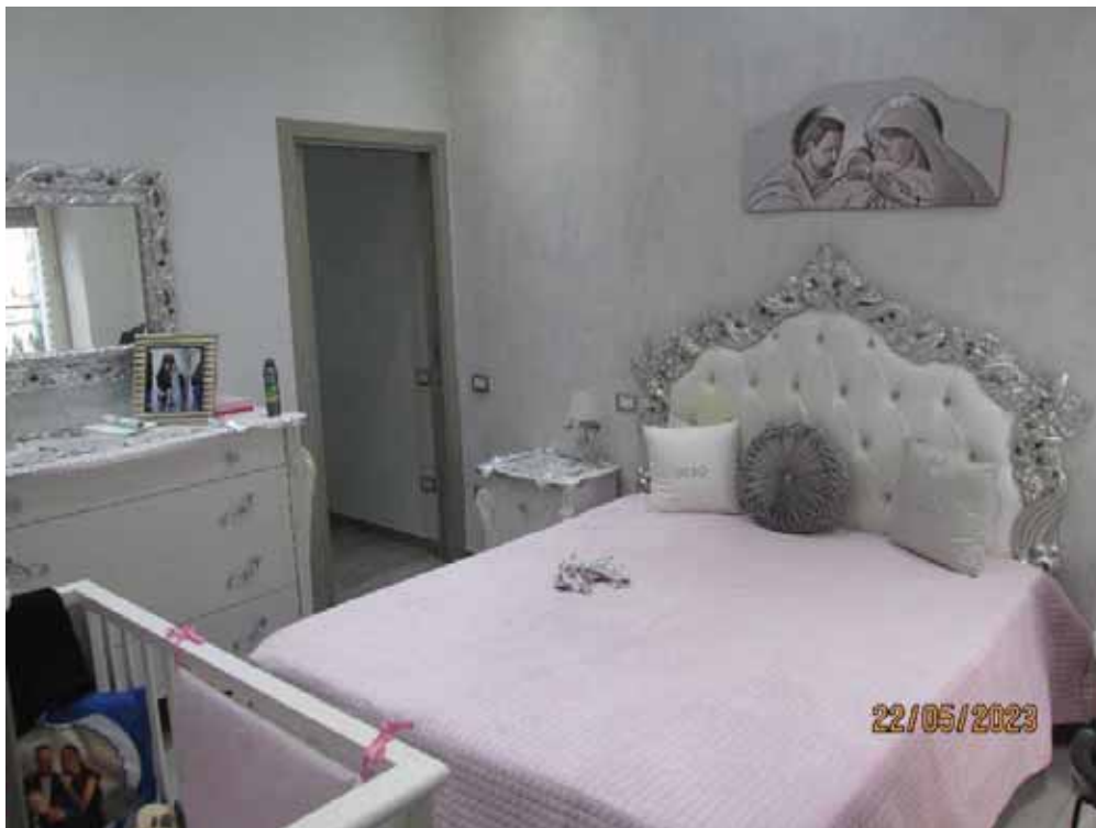
Fotografia 41 – Vano 3: Vi si accede dal “Disimpegno” e comunica con il “Vano 4” e con il “Bagno 2”, è adibito a camera da letto ed occupa una superficie utile netta pari a mq. 11,68 ed un'altezza dal piano di calpestio di ml. 3,60. La pavimentazione è costituita da piastrelle in gres porcellanato, le pareti rivestite con intonaci ordinari a finitura liscia e tinteggiate con pittura lavabile; il soffitto rivestito con intonaci ordinari a finitura liscia e tinteggiato con pittura a tempera.
