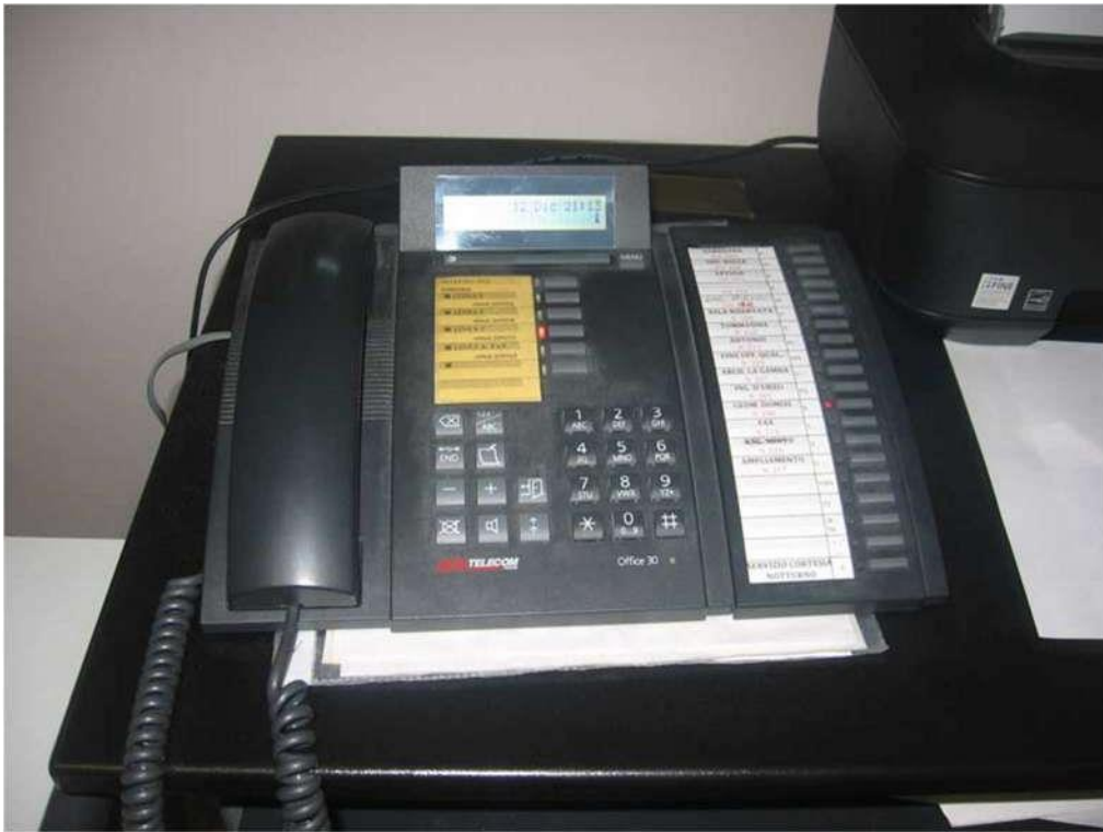
Foto n. 217: centralino Ascom BCS 64S
