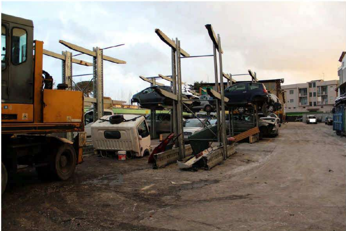
Foto 29: scaffalature metalliche per lo stoccaggio degli autoveicoli dopo la bonifica.
