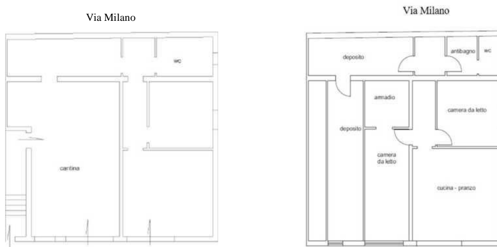
Fig. 25- Piano terra sub 3 (il piano risulta seminterrato) - Confronto tra la planimetria catastale e stato di fatto.
